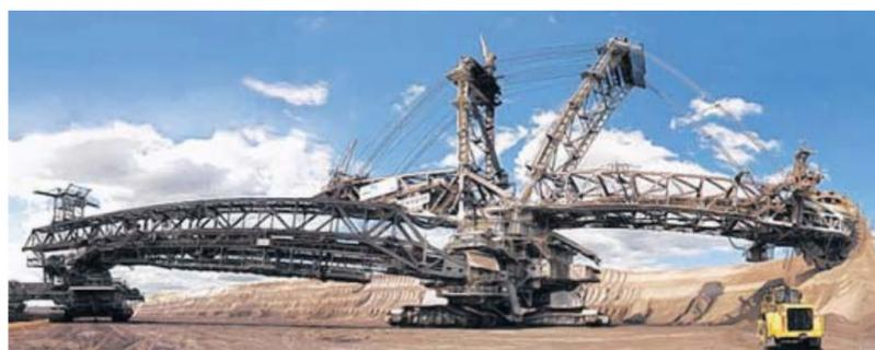
Hiermit werden Rohstoffe abgebaut: Der weltgrößte Schaufelradbagger 288 kommt im Braunkohletagebau Garzweiler zum Einsatz. Dorthin führt eine Reise von Mann-O-Mann. FOTO: MANN-O-MANN
